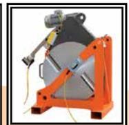
Soporte Placa térmica y Fresadora
