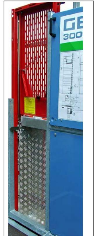
Haga ascender la plataforma hasta que el anclaje se pueda colocar a una altura idónea para el montaje.
