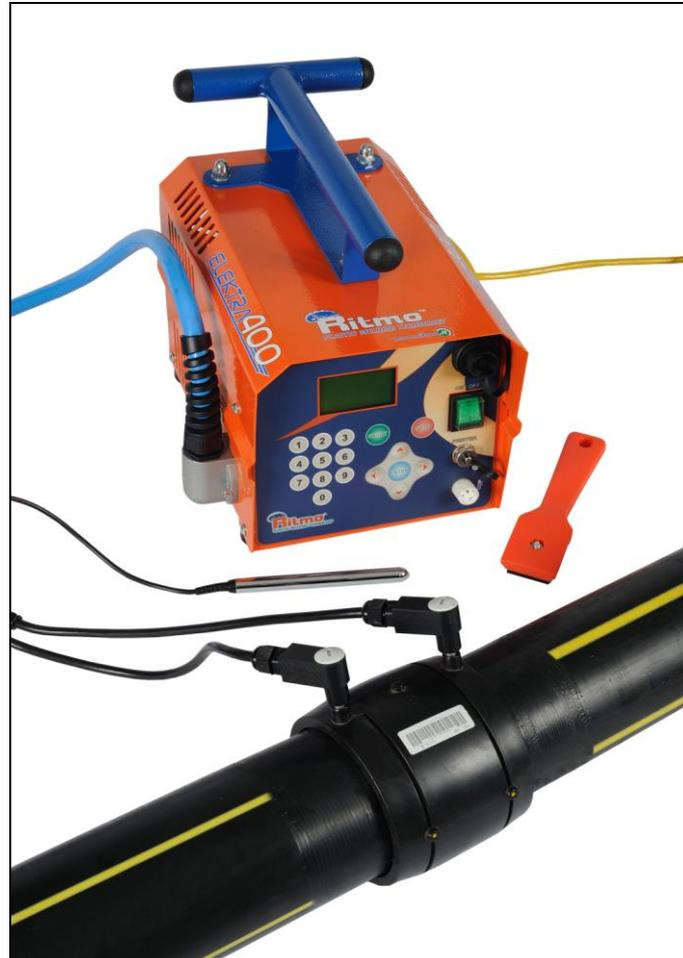
Conexión de los terminales o bornes
