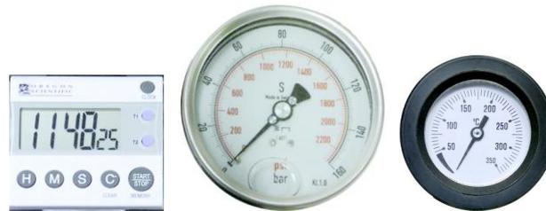
Para la ejecución de la soldadura el operador debe medir la fuerza de arrastre del carro móvil, referida al propio rozamiento y en relación a la carga a mover (tubos y/o accesorios). La presión necesaria para la fase de precalentamiento, calentamiento y soldadura, pueden ser relevadas de las tablas suministradas por RITMO junto con cada máquina.
