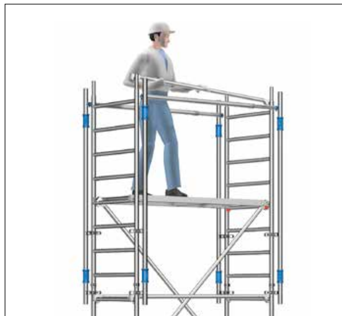
Fig. 6: Colocación segura de las barandillas con AGS
