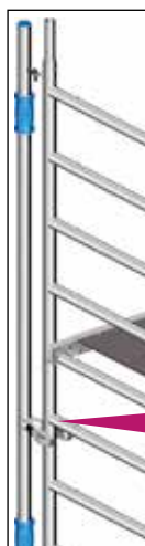
Fig. 4: Conexión del mástil al marco
