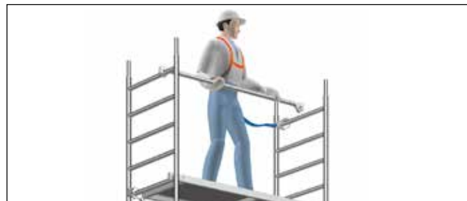
Fig. 3: Colocación de las barandillas con EPI
