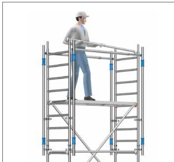
Fig. 6: Colocación segura de las barandillas con AGS
