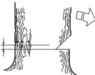
Coloque el apoyo de corteza (si ha sido montado) detrás de la faja de desgaje. Corte con aceleración máxima introduciendo lentamente la cadena/espada en el tronco. Preste atención a si el árbol se mueve en dirección opuesta a la elegida para el derribo. Tan pronto lo permita la profundidad de corte, ponga una cuña de derribo o una barra desgajadora en el corte de derribo.
