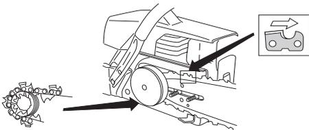
Compruebe que los filos de los eslabones de corte estén orientados hacia delante en la parte superior de la espada.
