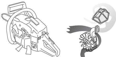
¡IMPORTANTE! Para que la depuración centrífuga funcione satisfactoriamente, debe efectuarse un mantenimiento constante del sistema.
