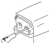
Si el silenciador de su máquina lleva rejilla apagachispas, límpiela a intervalos regulares. La obturación de la rejilla produce el sobrecalentamiento del motor, con el riesgo consiguiente de averías graves.
