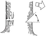
La convergencia de ambos cortes se denomina línea de corte de indicación. La línea de corte de indicación debe ser perfectamente horizontal y formar un ángulo recto (90°) con la dirección de derribo elegida.
