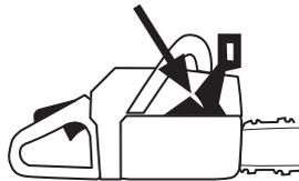
Empuje la protección contra reculadas adelante y atrás para comprobar que se mueve con facilidad y que está firmemente anclada a su articulación en la cubierta del embrague.
