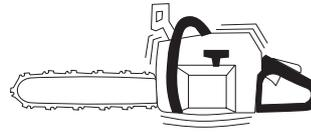
Las vibraciones que afectan al usuario de una motosierra tienen su origen en el contacto "irregular" entre la cadena y el árbol durante el corte.
