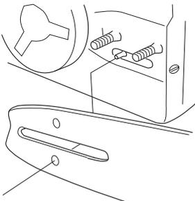
Tense la cadena enroscando en el sentido de las agujas del reloj el tornillo de tensado con la llave combinada. La cadena debe tensarse hasta que deje de colgar en la parte inferior de la espada.
