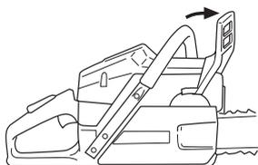
**Arranque:** El freno de cadena debe estar activado al poner en marcha la motosierra. Active el freno moviendo la protección contra reculadas hacia delante.
