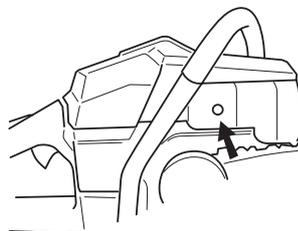
Aclaración: Si se ha montado el conjunto especial de invierno o si se han tomado medidas para aumentar la temperatura, debe cambiarse al reglaje normal, puesto que la máquina funciona con temperatura normal. De lo contrario, hay riesgo de sobrecalentamiento con las consiguientes averías graves del motor.
