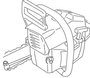
La cadena está correctamente tensada cuando no cuelga en la parte inferior de la espada y puede girarse fácilmente con la mano. Apriete las tuercas de la espada con la llave combinada, sujetando al mismo tiempo la punta de la espada.
