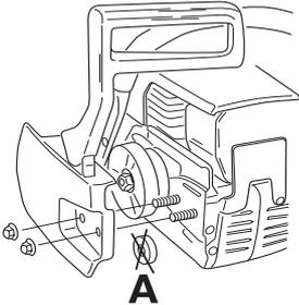
Monte la espada en los pernos. Sitúela en la posición posterior extrema. Monte la cadena en el piñón de arrastre y la guía de la espada. Empiece con la parte superior de la cadena.
