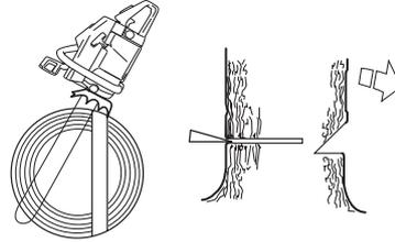
El corte de derribo debe quedar paralelo con la línea de corte de indicación, con una distancia mínima entre ambos de 1/10 del diámetro del tronco. La parte del tronco sin cortar se denomina faja de desgaje.
