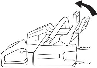
Desenrosque las tuercas de la espada y saque la cubierta del embrague (el freno de cadena). Saque la protección de transporte (A).
