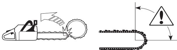
El corte con la parte inferior de la espada, en sentido descendente desde la parte superior del objeto a cortar, se denomina de corte con cadena tirante. La motosierra es tirada hacia el árbol y el canto delantero del cuerpo se apoya contra el tronco. Con esta técnica de cadena tirante, el usuario controla mejor la motosierra y la situación del sector de riesgo de reculada de la espada.
