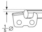
Es muy difícil afilar correctamente una cadena sin accesorios adecuados. Por consiguiente, le recomendamos que utilice nuestro calibrador de afilado. Éste garantiza un afilado que reduce óptimamente las reculadas y maximiza la capacidad de corte.
