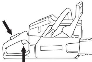
Dado que el freno de cadena todavía está activado, se deben bajar las revoluciones del motor lo antes posible a ralentí, y esto se logra desconectando rápidamente el fiador contra aceleraciones involuntarias. De ese modo, se evita un desgaste innecesario del embrague, del tambor del embrague y de la cinta de freno.
