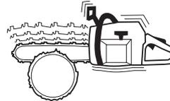
El corte de maderas duras (la mayoría de los árboles caducifolios) produce más vibraciones que el de maderas blandas (la mayoría de las coníferas). El corte con un equipo de corte desafilado o incorrecto (modelo incorrecto o mal afilado) incrementa el nivel de vibraciones. Vea las instrucciones bajo el título Equipo de corte.
