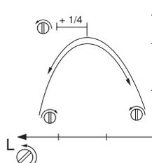
Busque el régimen máximo de ralentí girando lentamente en el sentido de las agujas del reloj y en sentido contrario a las agujas del reloj el surtidor de bajo régimen L. Cuando encuentre el régimen máximo, gire en sentido contrario a las agujas del reloj el surtidor L 1/4 de vuelta.
