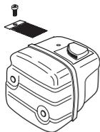
Nunca utilice un silenciador sin una rejilla apagachispas o con una rejilla apagachispas defectuosa.
