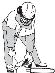
Agarre el mango delantero con la mano izquierda. Pise la parte inferior del mango trasero con el pie derecho y presione la motosierra contra el suelo. Agarre la empuñadura de
