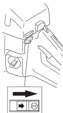
Para parar el motor, desconecte el encendido. (Empujando el botón de parada hacia la derecha.)
