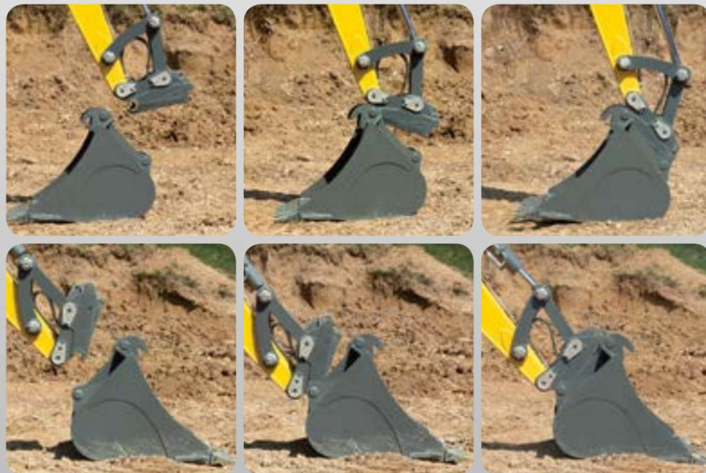
**Inteligente a la hora de utilizar la cuchara excavadora.** Mediante un sencillo giro también puede utilizarse la cuchara como pala de arrastre. De esta forma no solamente se ahorra tiempo sino que también se incrementa la flexibilidad de la excavadora.
