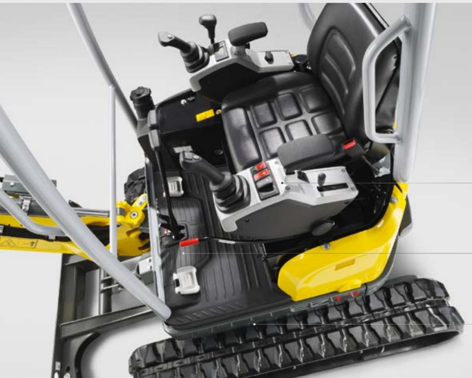
**Todo a la vista y todo controlado.** El soporte de mandos modular permite un concepto de control completamente nuevo con la máxima visibilidad y seguridad: Todo se encuentra a mano y a la vista gracias a la perfecta integración del panel de interruptores, la pantalla, el control proporcional, la palanca de gases, el soporte de brazo ajustable y la palanca de la pala niveladora.
