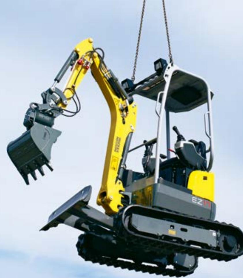
**Trasladarla rápidamente a otro lugar:** Los puntos de izaje incorporados en el tejadillo permiten trasladar o levantar la máquina de forma rápida y sencilla con el práctico dispositivo de izaje de dos puntos.
