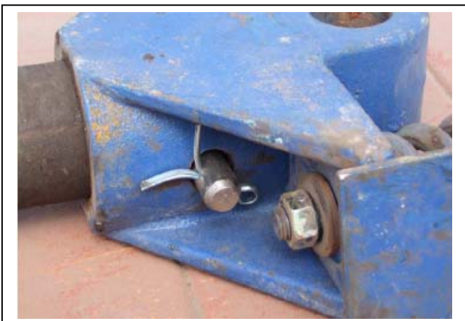
3.- Colocar Bulón de 20mm con chavetas.
