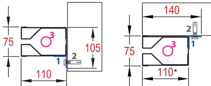
**MÉTODOS DE FIJACIÓN DE LAS GUÍAS LATERALES**
