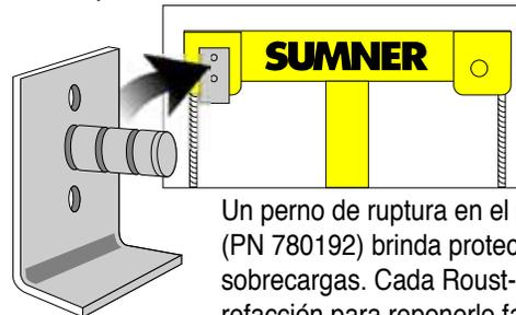
Un perno de ruptura en el polipasto de carga (PN 780192) brinda protección contra sobrecargas. Cada Roust-A-Bout viene con una refacción para reponerlo fácilmente en el campo.
