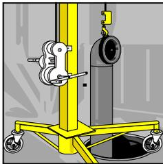
Por el diseño especial de el Roust-A-Bout, se pueden colocar cargas por debajo del nivel del piso.
