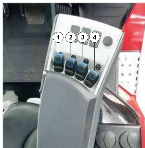
Figura 30: Mandos hidráulicos de minipalanca
