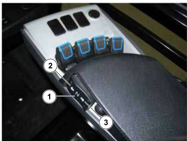
Figura 27: Selector de marcha desde las minipalancas
