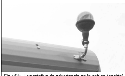
Fig.: 51: Luz rotativa de advertencia en la cabina (opción)
