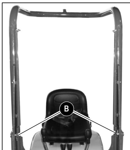
Fig. 86: Bajar la barra antivuelco
