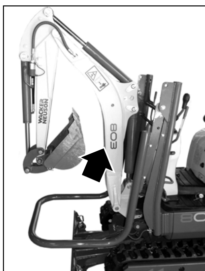
Fig. 88: Bajar la barra antivuelco
