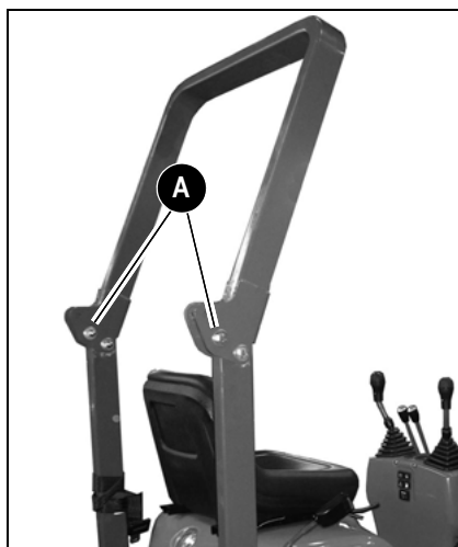
Fig. 82: Bajar la barra antivuelco
