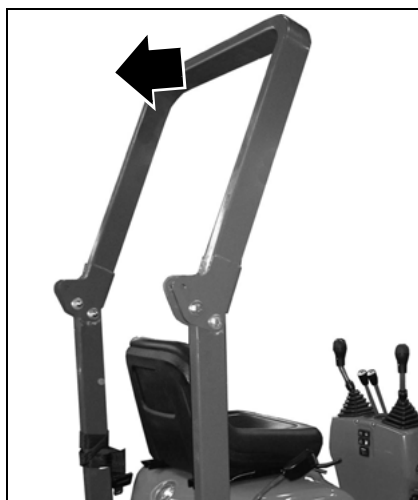
Fig. 83: Bajar la barra antivuelco
